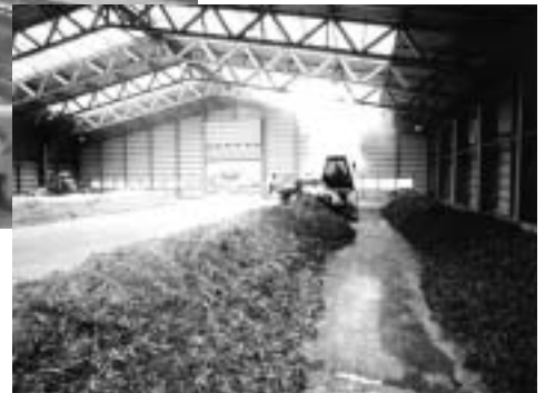
コンポストヤードでの汚泥切り返し作業（下水汚泥を有機肥料に加工するための作業）
